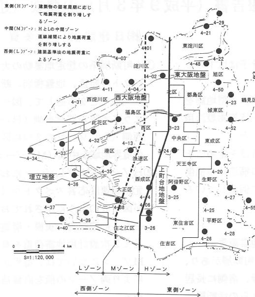
注1) 図中●印は地震動の計算ポイントを示す。
