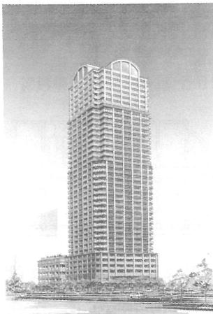
セットバックしているが、整形であり、地上部分の幅高さ比(建物高さ/建物幅)は南北方向・東西方向とも3.3となっている。また、地盤への建物根入れ深さは、建物高さの6.3%を確保している。
