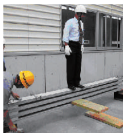
写真-1 載荷試験
