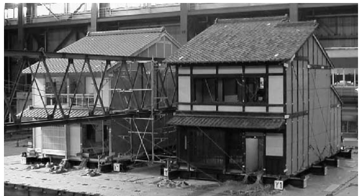
写真1 京町屋試験体
