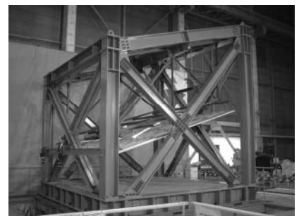
3軸振動台による天井振動実験
