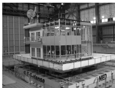
図-4 震動台上の試験体
