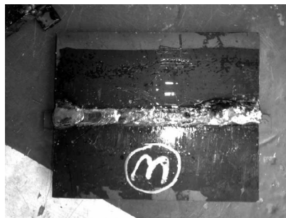
溶接完了後の試験体例
