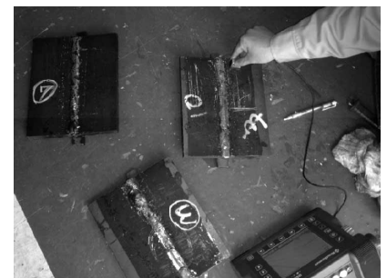
UT検査の状況
