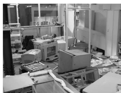
図-5 加震後の試験体内部
