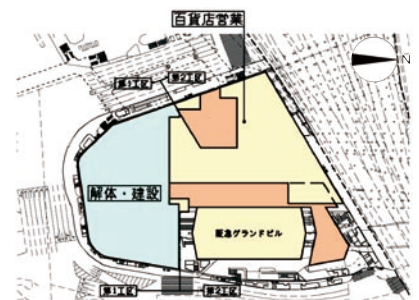
② 仮店舗の開業、第1工区(南側)百貨店の解体、建設
