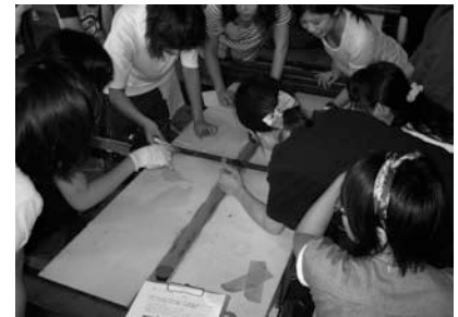
写真1 クラックスケールを用いたひび割れ観察
