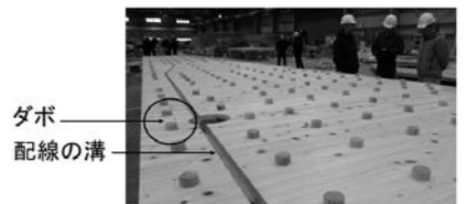
CLTの工場加工 (銘建工業にて)
