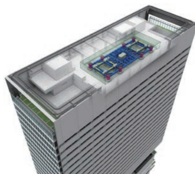
図1 TMDの設置場所
