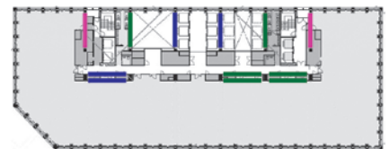
図4 上層オフィス階の制振部材配置
